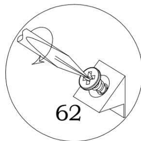
Стяжку для задних стенок **62** вставить до упора в пазы, расклинив заднюю стенку, и зафиксировать её шурупом.
