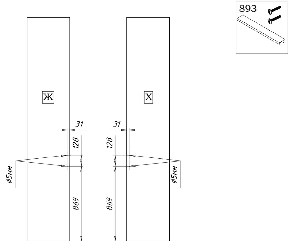
1. На лицевой поверхности двери Ж или X аккуратно разметить и просверлить сквозные отверстия  $\phi 5\text{мм}$  согласно схеме.
