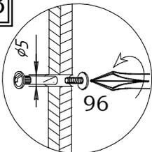
Соединить изделия при помощи межсекционных стяжек **96** через отверстия в стенках боковых. Отверстия  $\phi 5$ мм просверлить электродрелью в стенках боковых, предварительно выровняв изделия по высоте.
