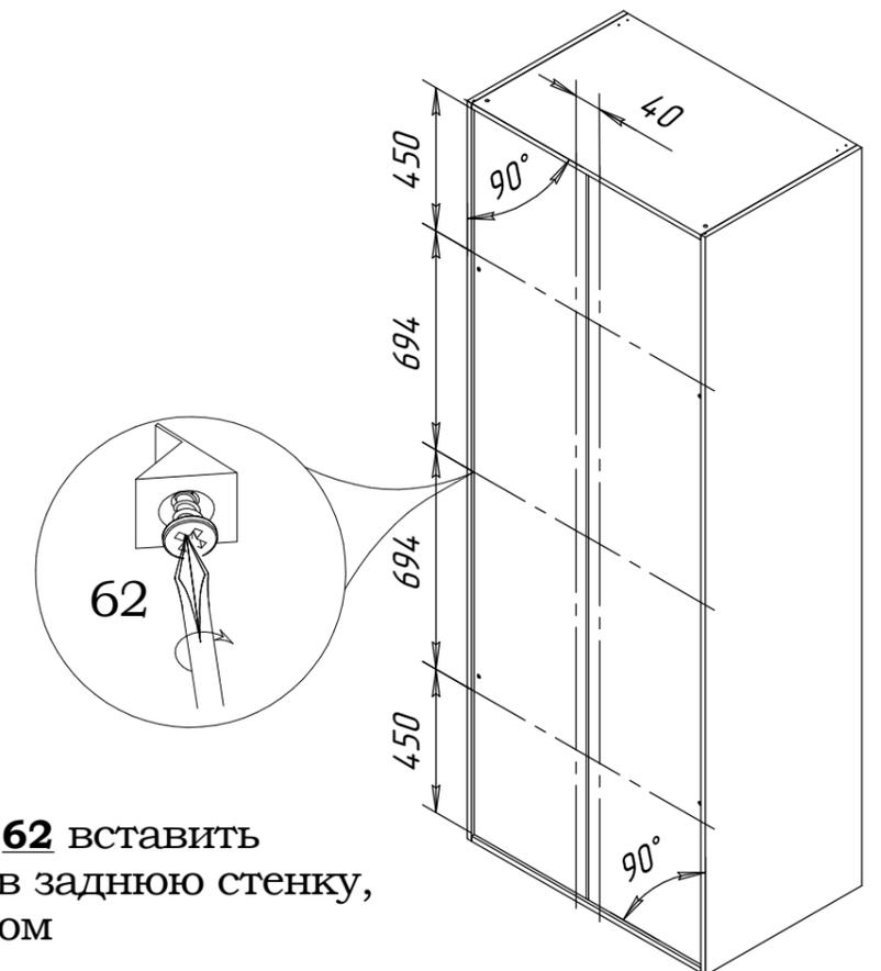
Стяжку для задних стенок **62** вставить до упора в пазы, расклинив заднюю стенку, и зафиксировать её шурупом
