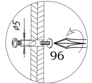
Отверстия  $\phi 5$  мм просверлить электродрелью в стенках боковых, предварительно выровняв изделия по высоте.
