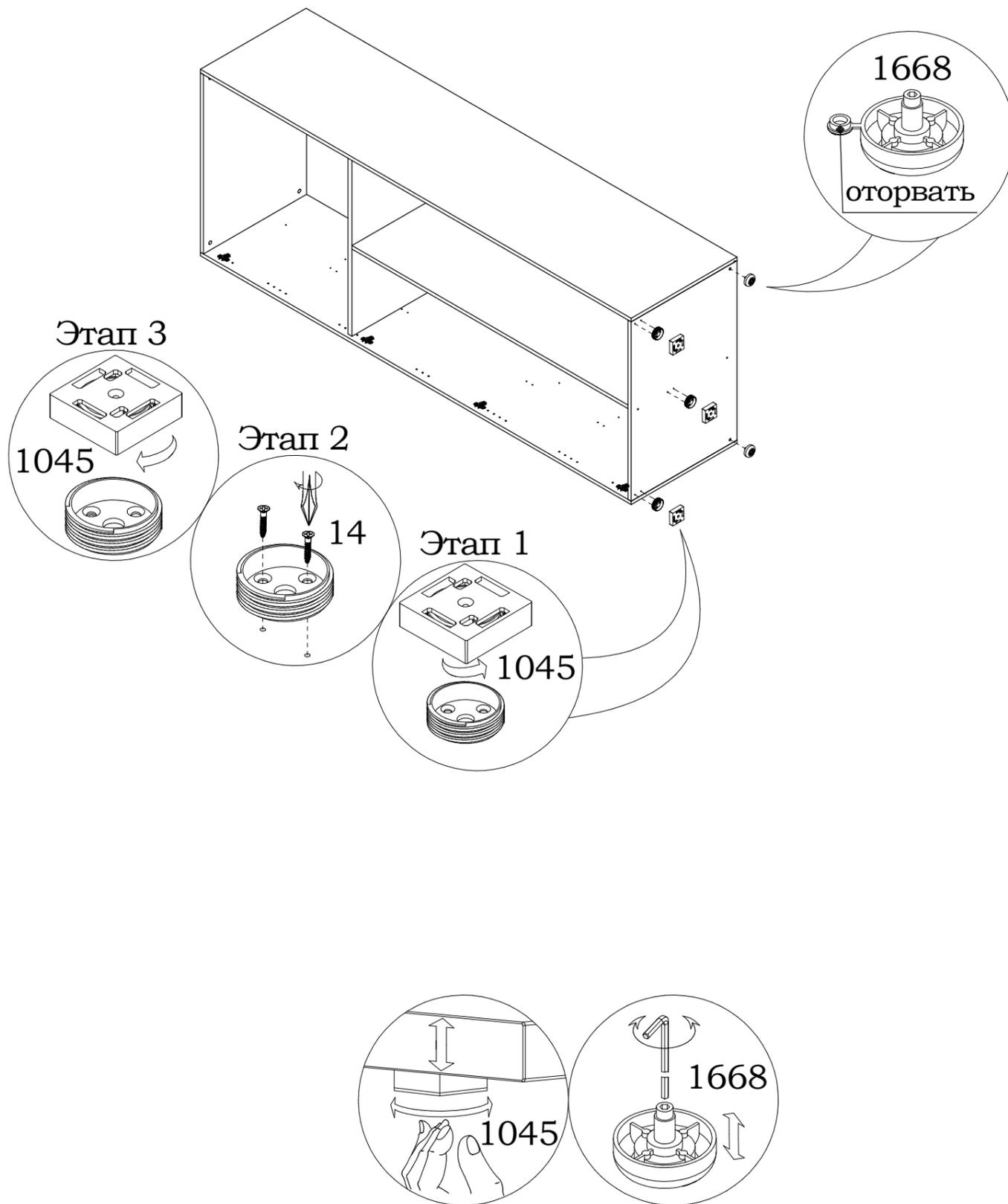
Выравнивание изделия по высоте спереди произвести поворачиванием вращающихся частей регулируемых опор **1045**, а сзади вращением опор **1668** с помощью шестигранного ключа.
